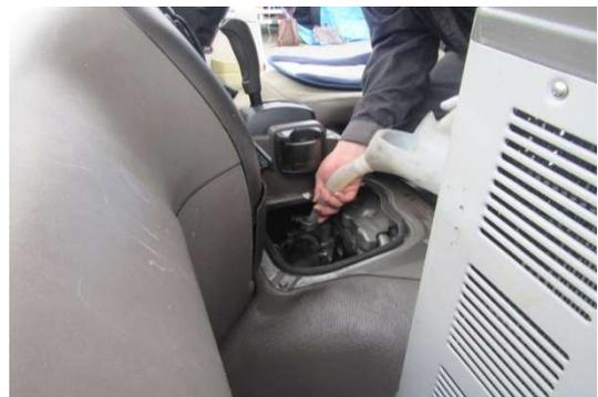
写真11 冷却水の注入
