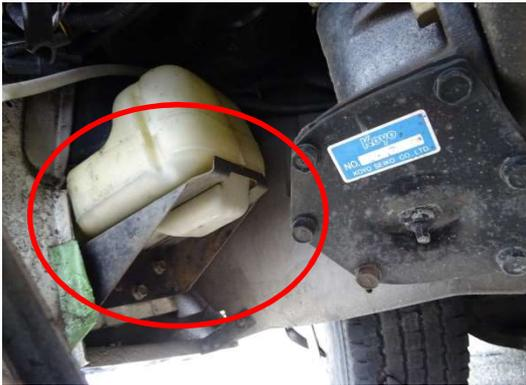
写真8 ラジエータサブタンク
