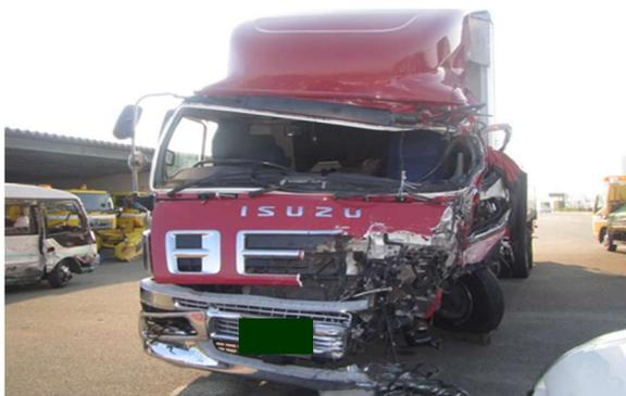
写真1 当該車両の損傷状況（前面）
