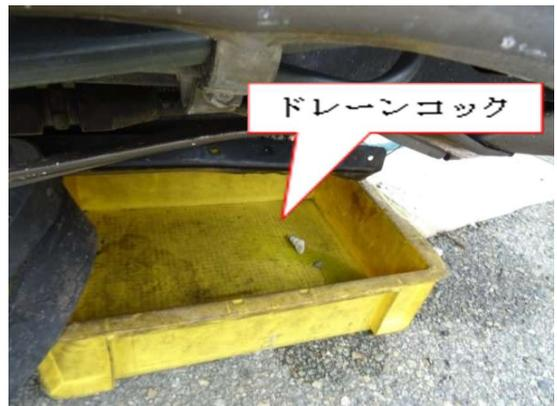
写真9 冷却水の収集
