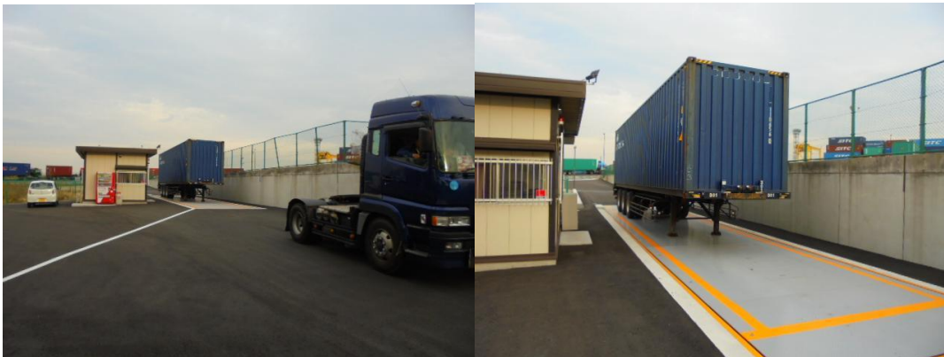
トラクターヘッドを切り離れた計量の例（ピット式トラックスケール）
