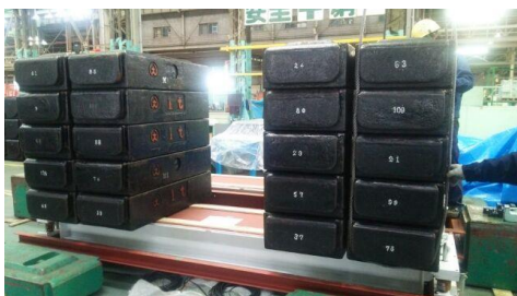
【分銅(1t)による点検・調整】
