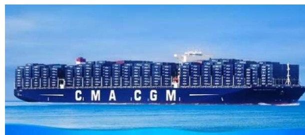
LNG燃料大型コンテナ船のイメージ (CMA-CGM社、2020年9隻竣工予定、22,000TEU型)
