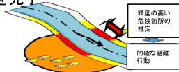
河川の左右岸別のリスクを連続的な線の情報として表示
