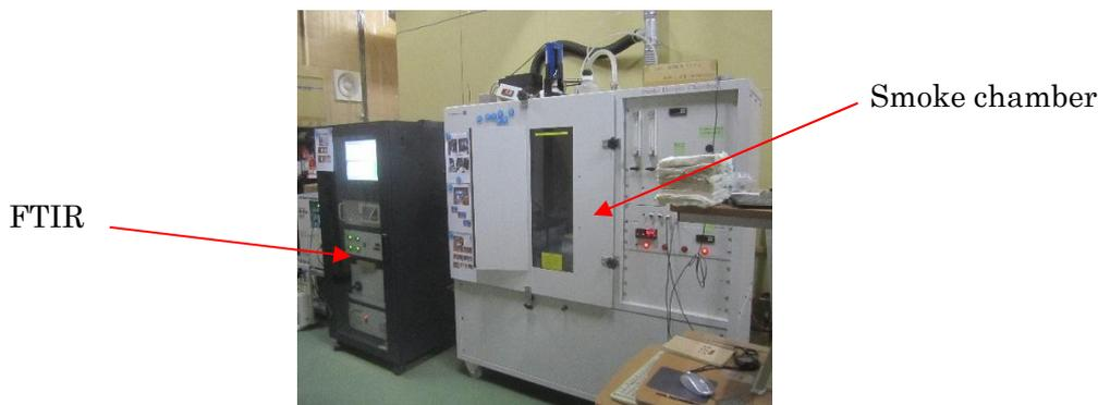
図 SDC (Smoke Density Chamber)及び FTIR が連結された状態
