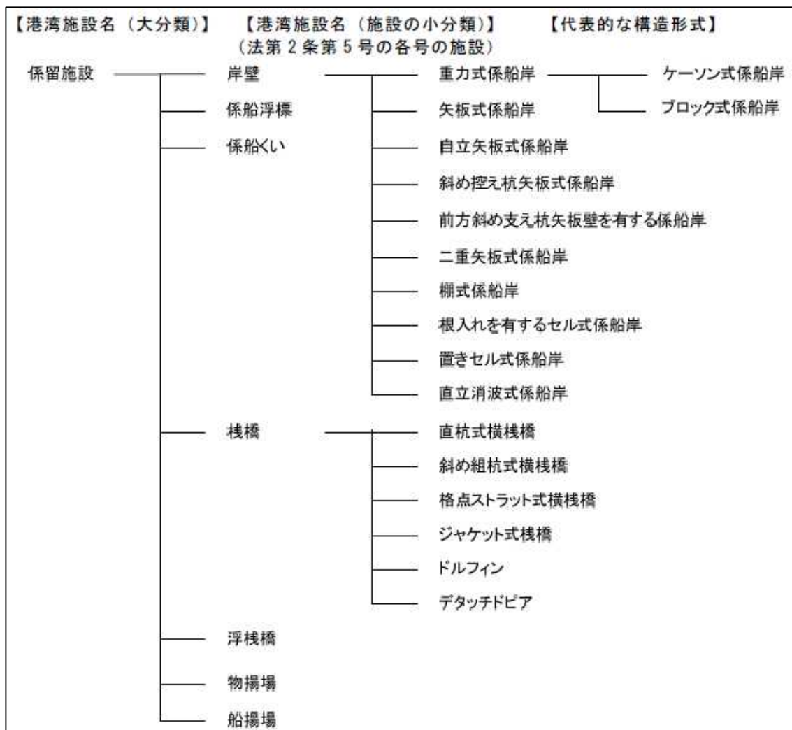
図・参-2.2.1.1 係留施設の種類及び代表的な構造形式
