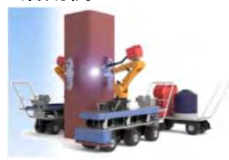
溶接ロボット
