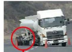
横転限界を超え、試験車両の横転防止車輪が路面に接触。
