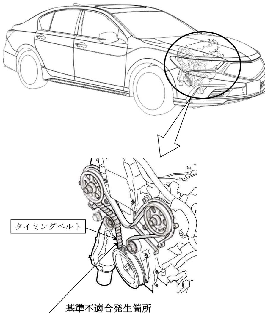
原動機のタイミングベルトにおいて、当該ベルトの製造工程が不適切なため、ベルト歯の強度が不足しているものがある。そのため、そのまま使用を続けるとベルト歯が損傷して、警告灯、警告表示が点灯し、最悪の場合、エンジンが停止して再始動できなくなるおそれがある。
