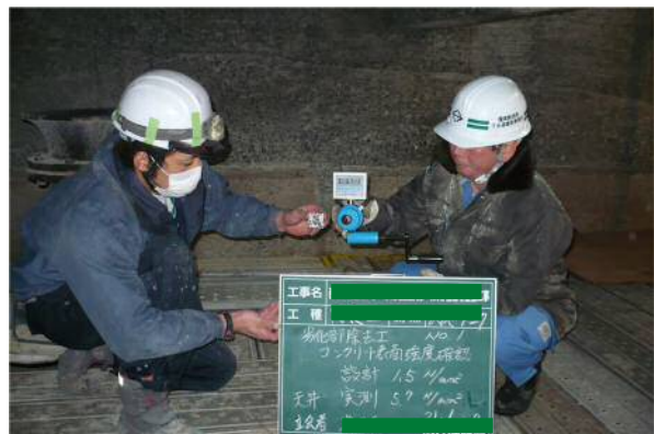
図 2-14 表面強度試験(5.7N/mm 2 )
