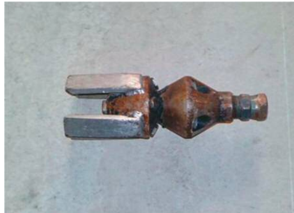
モルタル除去ノズル (先端でモルタルを破碎)
