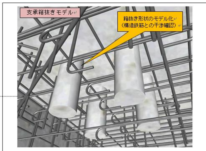
図 30 モデルイメージ（支承箱抜き：下部工）
