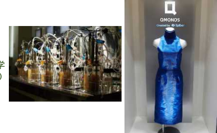
写真左：人工合成クモ糸繊維QMONOST™の製造工程。微生物に合成したクモタンパク質のDNAを導入し、培養して数を増やす。 写真右：人工合成クモ糸繊維QMONOST™が使われた世界で初めてのドレス（2013年5月発表）。（写真提供：Spiber）
