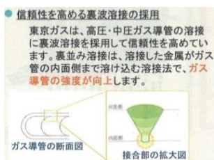
図－高圧・中圧ガス導管の耐震性を支える技術例
