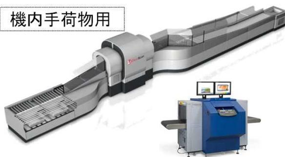
機内持込・受託手荷物のX線検査機器のうち、爆発物を自動的に検知するシステム
