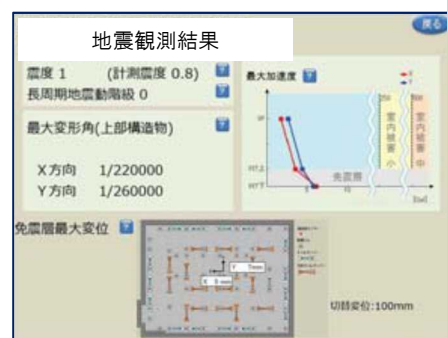
図一 地震モニタリングシステムの表示イメージ
