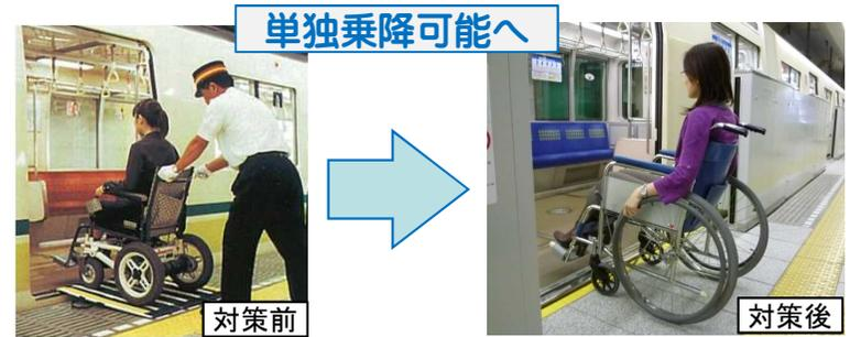
車椅子使用者による実証試験の結果からは、段差2cm・隙間5cmが理想的(全ての被験者が乗降可能)
