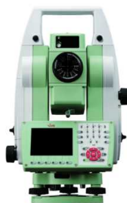
KUMONOS 足場設置不要の高所ひび割れ計測（ラマⅧ世橋）
