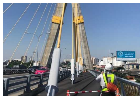
KUMONOS 足場設置不要の高所ひび割れ計測（ラマⅧ世橋）
