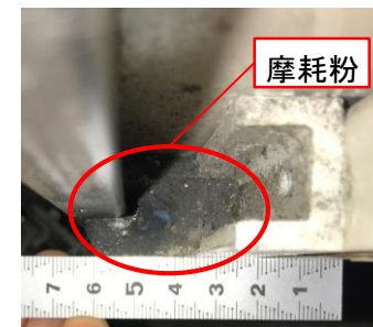
写真4 2階上側の戸下端の ドアガイドシュー
