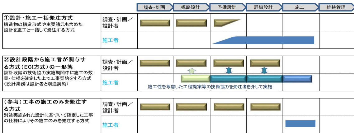
図2-1 技術提案・交渉方式の適用が考えられる契約方式（イメージ）
