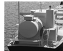
新燃料貯蔵・供給・燃焼システム
