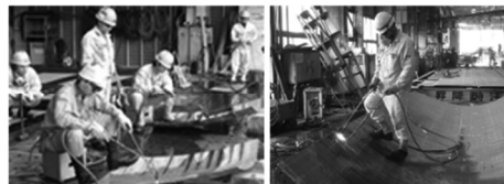
ぎょう鉄（鉄板曲げ加工）
