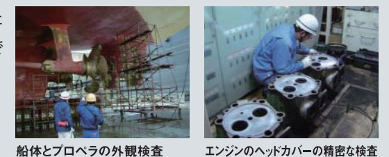
船体とプロペラの外観検査 エンジンのヘッドカバーの精密な検査
