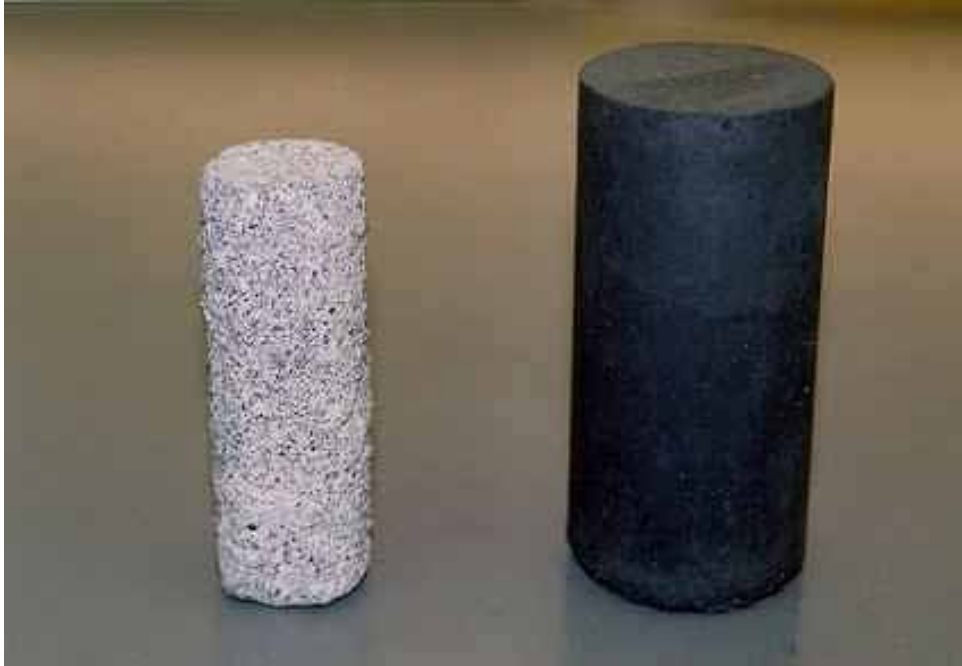
耐硫酸モルタル(10%硫酸溶液に4週間浸漬したモルタルの外観)
