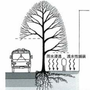
車道の路盤（根の伸長不可部） 根の伸長できる硬度で、透水・通気性のある路盤 出典：街路樹／山本紀久著
