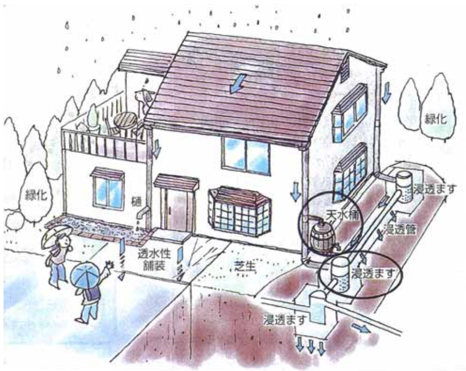
図1 - 3 4 雨水貯留・浸透施設設置に対する補助制度事例 資料：仙台市
