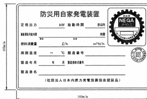
図 2-5-1-1. 表示板（防災用自家用発電装置）
