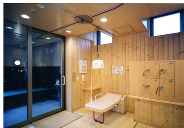
▲家族風呂：脱衣所から浴室に連続した介護リフトを設置 更衣室に設けた折りたたみ式ベッド（左写真） 車いす使用者用の洗い場及び浴室移乗台（右写真）
