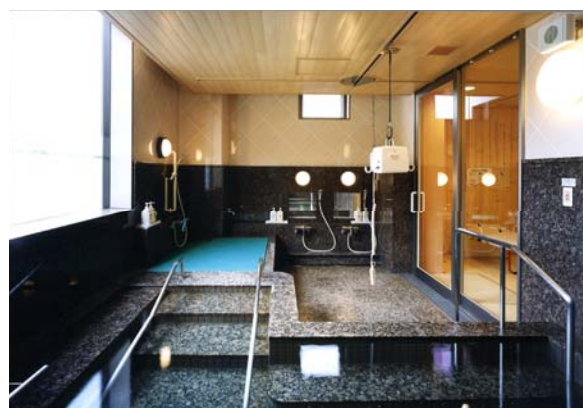
▲家族風呂：脱衣所から浴室に連続した介護リフトを設置 更衣室に設けた折りたたみ式ベッド（左写真） 車いす使用者用の洗い場及び浴室移乗台（右写真）
