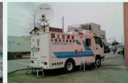
【石巻市に設営された衛星通信車】
