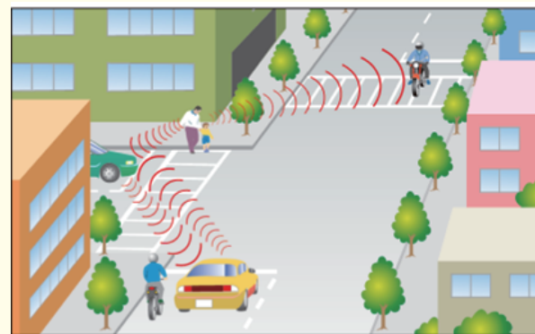
図表 II-9-1-2 通信を利用した運転支援イメージ（先進安全自動車（ASV））
