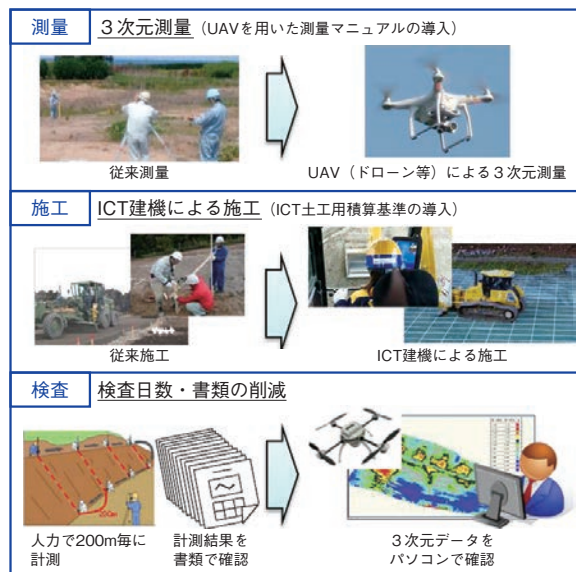
図表1-3-3 i-Constructionの推進（ICT土工の流れ）
