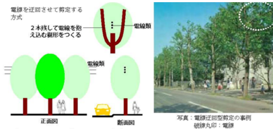
図表 2.22 街路樹により隠された電線類の事例
