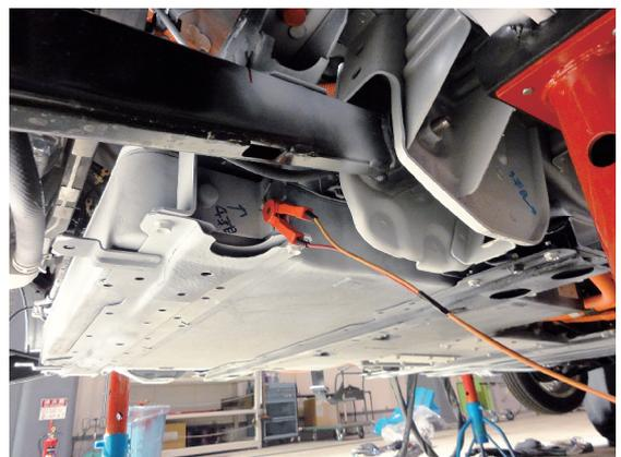
⑦高電圧バッテリーからの液漏れ及び固定状況の確認
