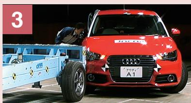
3 側面衝突試験後にドアの解放状況の確認を行っている様子
