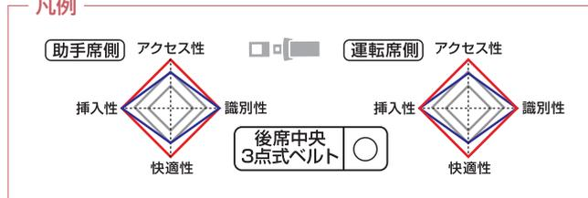
赤線はシートポジションが標準位置、青線はシートポジションを前方に移動した位置における評価を表しています。
