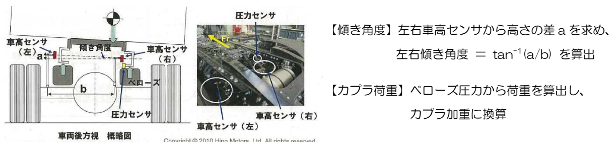
図36 左右傾きの検出原理
