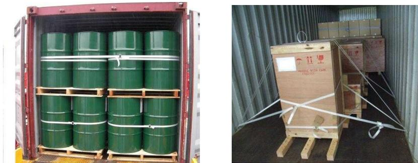
図 6.5 コードストラップを使用した固定
