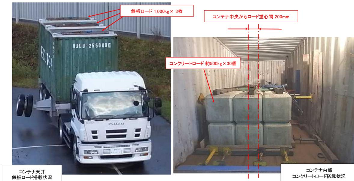
図 3.6 偏荷重あり時における 20ft コンテナのロード積載例（初年度）
