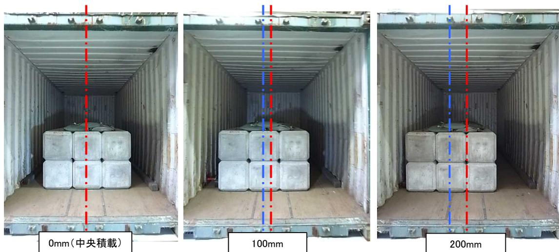
図 3.17 左右重心位置別に見た積載物積載状態（20ft2 軸トレーラー）
