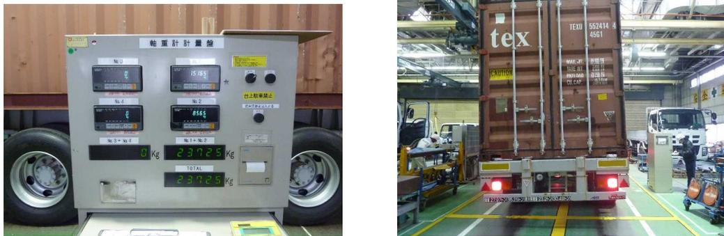
図 3.20 重量計と重量計測の様子
