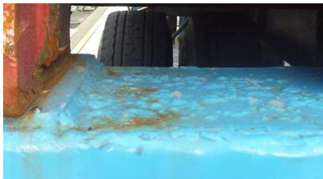
図 5.12 シャーシ床面の凹凸状態の例
