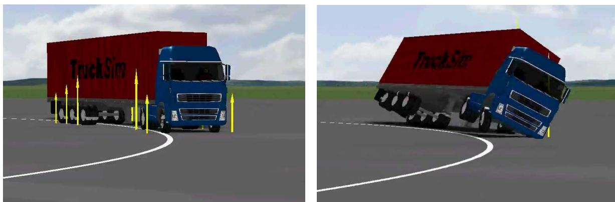
図 3.11 「TruckSim」によるシミュレーション結果（動画）の一例
