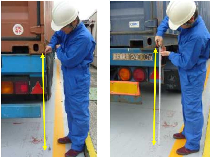
図 5.4 おもりを付けた紐（写真左）、メジャー（写真右）によるトレーラー後部のシャーシ床面の高さの計測例
