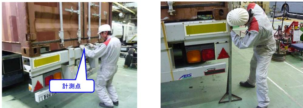
図 3.19 傾斜角、高さの計測の様子
