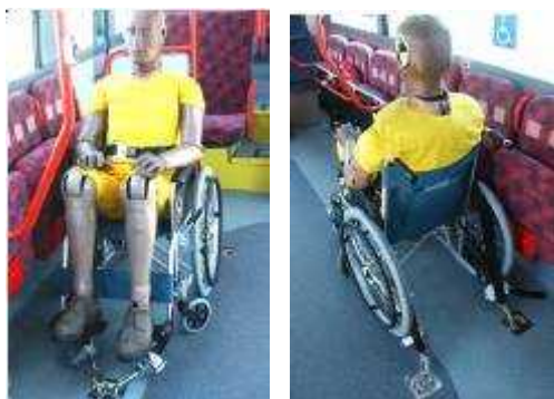
3点ベルト式車いす固定装置 (2点式シートベルトの装着も必要)
