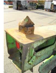
緊締装置 （ツイストロック）
