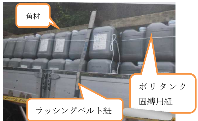
写真6 固縛状況（荷台右側からみた）
