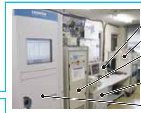
動力計制御指令装置 モータ用電源装置 高速演算装置 車両モデル指令装置 排出ガス分析装置
