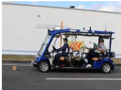
15cm角の障害物試験と停止後の遠隔監視モニタ確認
