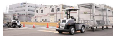
L4自動運転EVを用いた屋外対応型無人搬送サービス「eve auto」
