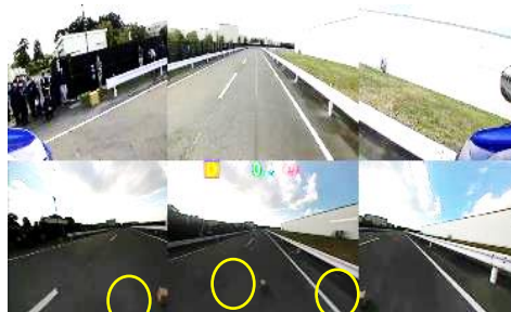
15cm角の障害物試験と停止後の遠隔監視モニタ確認
