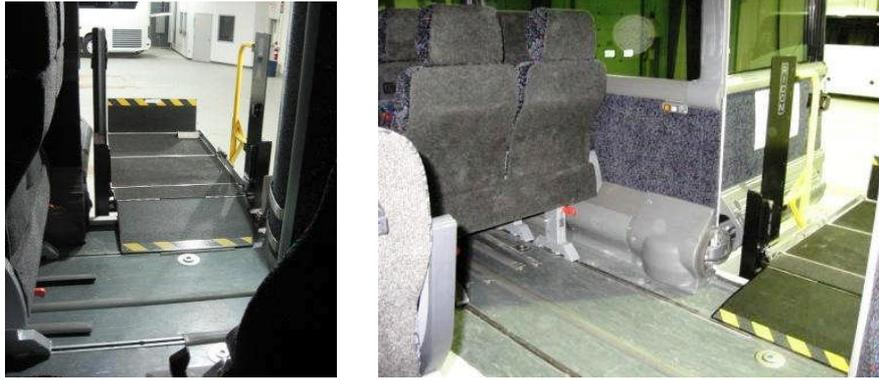
図 2.18 後輪の後方にリフトを装備した例
