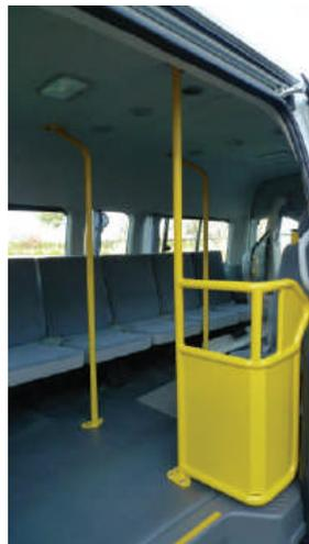
図42 乗降口手すりの配置（実車の写真）
