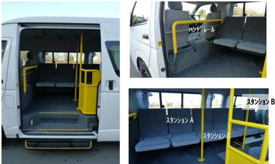
図 40 車内の手すりの配置 (実車の写真)
