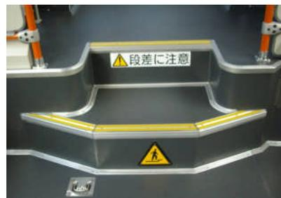
図2.4 後部立席拡大車両の段差
