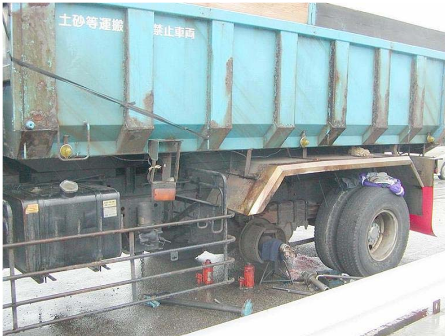
図表 8 ホイール・ボルト折損による車輪脱落事故の事例
