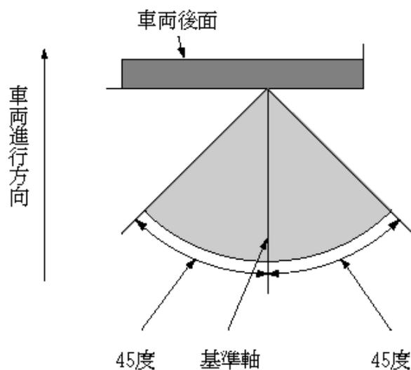
(注) 上図に示した角度は、車両の右側に装着する場合を示す。
