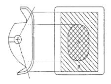
照明部の大きさとは、別に定めるもののほか、自動車の前方又は後方に向けて照射又は表示する灯火器又は指示装置にあっては車両中心面に直角な鉛直面への投影面積とし、自動車の側方に向けて照射又は表示する灯火又は指示装置にあっては、車両中心面に平行な鉛直面への投影面積とする。この場合において、不透明なモール等により仕切られた照明部にあっては、当該モール等に相当する部分の投影面積を除くものとする。
