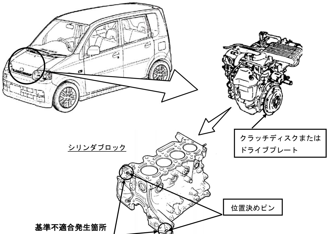
原動機において、シリンダーブロックに変速機を固定するための穴の位置が不適切なため、原動機と変速機の軸がずれて組み立てられたものがある。そのため、そのままの状態で使用を続けると、手動変速機のクラッチディスクまたは自動変速機のドライブプレートが損傷し、最悪の場合、走行不能に至るおそれがある。
