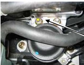
識別：エンジンルーム右側にあるNo. 3エンジン・マウント・スタッド・ボルト(室内側)の頭に黄色ペイントを塗布する。
