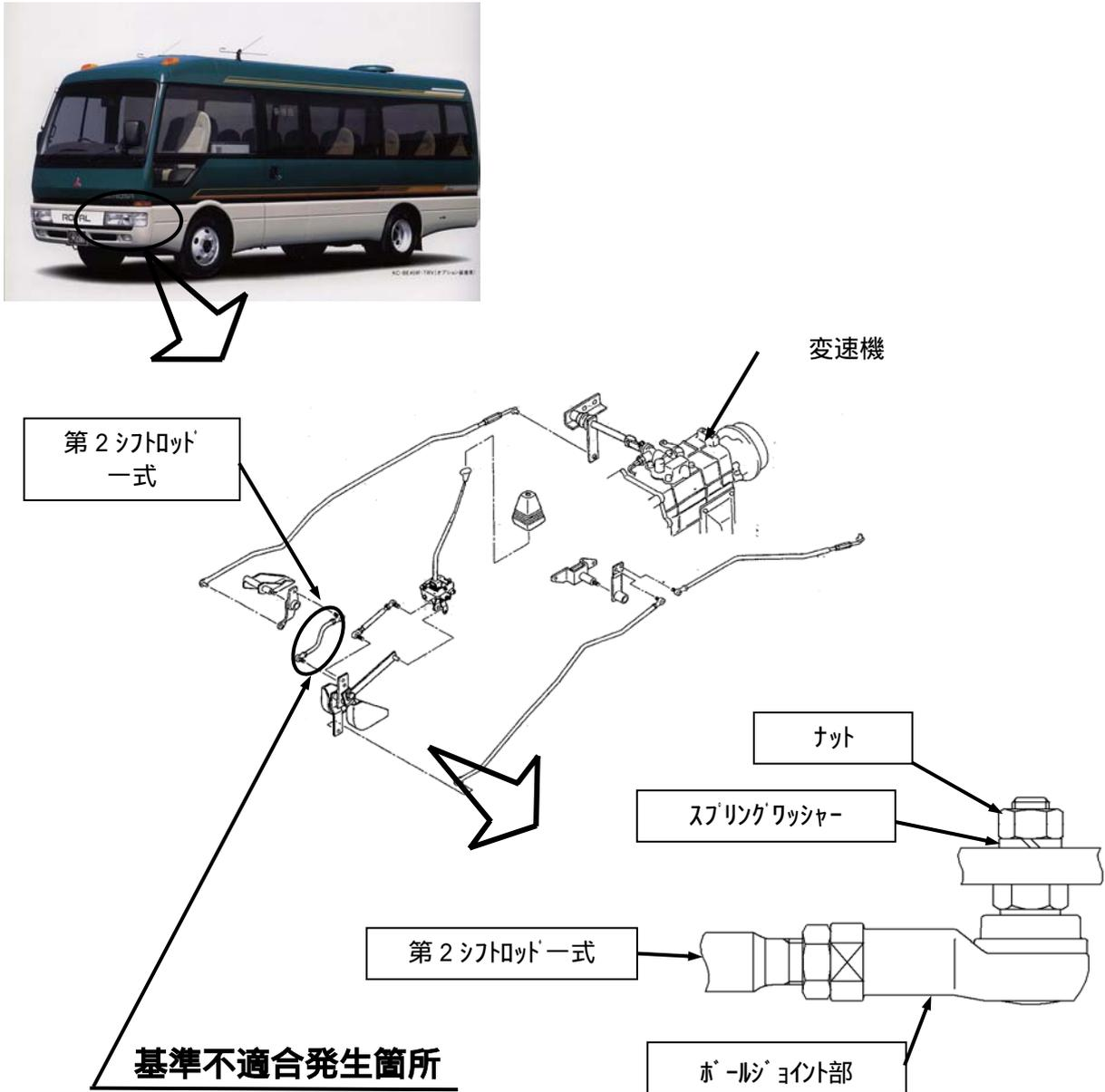
変速機の第2シフトロッドボールジョイント部の強度が不足しているため、変速操作時に亀裂が発生するものがある。そのため、そのままの状態で使用を続けると、当該部が折損して変速不能となり、最悪の場合、走行不能となるおそれがある。
