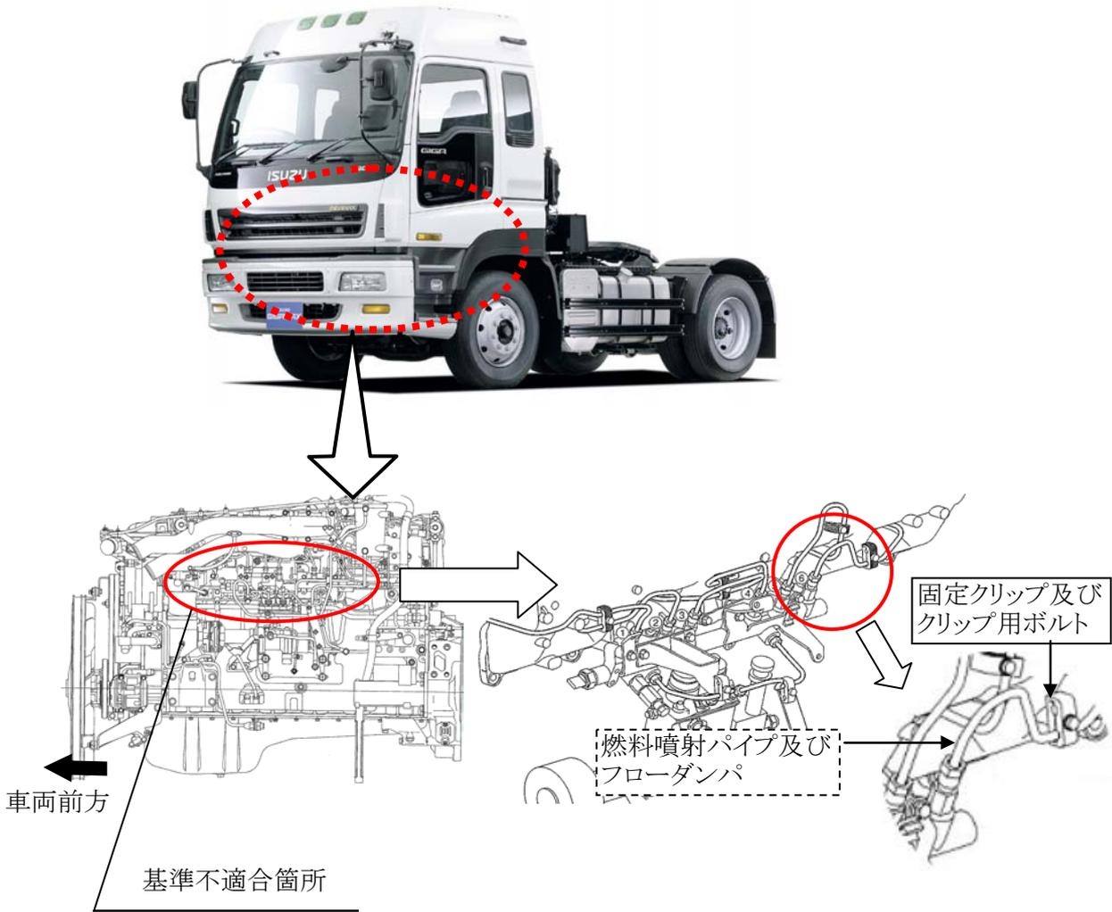
燃料噴射パイプの固定クリップの構造が不適切なため、エンジン振動等により当該クリップが外れるものがある。そのため、そのまま使用を続けると、燃料噴射パイプまたはフローダンパ（流量を制御する部品）が折損し、燃料が漏れるおそれがある。
