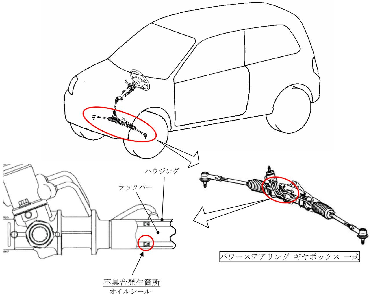
パワーステアリングギヤボックス内のラックバーの組付け作業が不適切なため、ギヤボックス内のオイルシールを損傷させたものがある。そのため、そのまま使用を続けると、損傷が進行し、オイルが漏れ、最悪の場合、ハンドルの操作力が増大するおそれがある。
