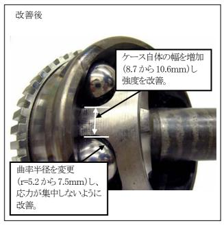
フロントドライブシャフトにおいて、ホイール側ジョイント部のボールベアリングケースの強度が不足している ものがある。そのため、ハンドルのすえ切りなどを頻繁に繰り返すと、当該ケースに亀裂が発生することがあり、 そのまま使用を続けると当該ケースが破損し、最悪の場合、走行できなくなるおそれがある。
