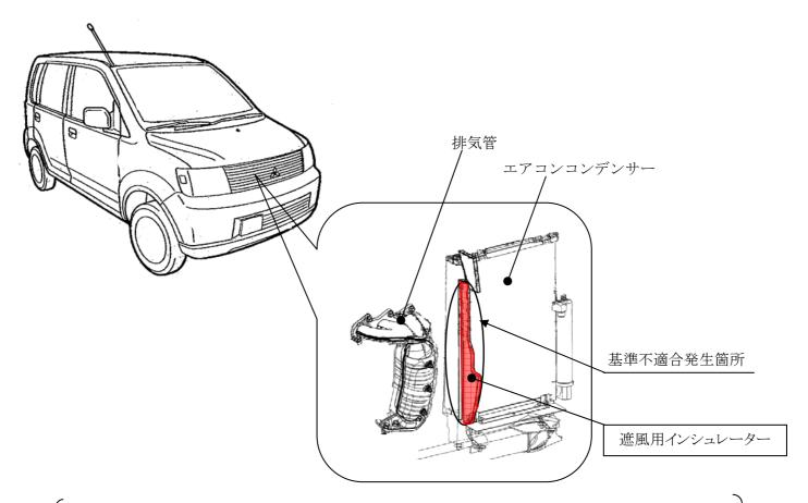
エンジンルーム内のエアコンコンデンサー前側に装着している遮風用インシュレーターの材質が不適切なため、使用過程において当該インシュレーターが取付部より破断することがある。そのため、走行中破断したインシュレーターが排気管に接触し、最悪の場合、インシュレーターが焼損して、火災に至るおそれがある。
